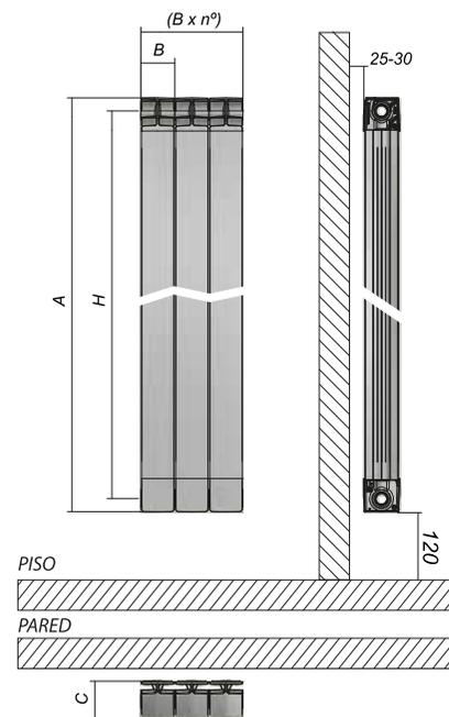
Aplomado con respecto a la pared y con un desnivel leve ascendente respecto de la horizontal del piso hacia el grifo de purga, para permitir la correcta evacuación de aire.
